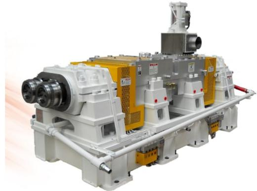
Per applicazioni di riciclo meccanico, il mescolatore presenta un'ampia bocca di alimentazione che consente l'introduzione di materiale di forma anche irregolare e possibilità di alimentare frazioni a bassa densità apparente.
