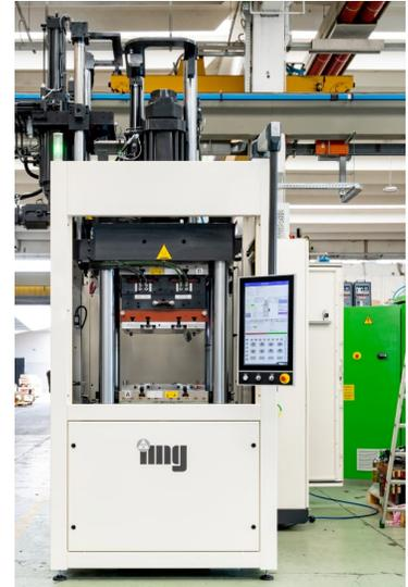
La nuova versione verticale della serie VCV (nella foto) è rivolta allo stampaggio di gomma e di silicone, sia solido grazie all'aggiunta di un'apposita tramoggia, che liquido (LSR) mediante l'inserimento di una pompa di dosaggio dei due componenti.
