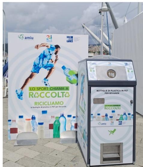
Alimentato con energia solare, Smart Solar Bin raccoglie e al tempo stesso riduce il volume delle bottiglie introdotte dai cittadini, monitorando in tempo reale il proprio stato di riempimento grazie a sensori collocati al suo interno; ciò consentirà di ottimizzare gli svuotamenti e la gestione complessiva degli apparecchi.
