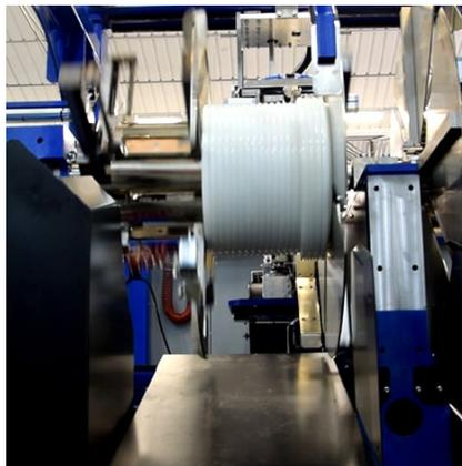
Ogni aspo è completamente regolabile in diametro e larghezza: il diametro interno può essere facilmente impostato, per ognuno dei 4 bracci, attraverso una vite senza fine, mentre la larghezza è centralizzata con regolazione dal centro della bobina. Attraverso il sistema di guida tubo integrato si ottiene una
