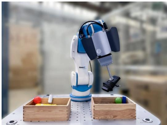
Il costruttore italiano di sistemi di automazione Comau ha messo a punto Mi.Ra/OnePicker, una soluzione collaborativa, basata su visione e intelligenza artificiale con autoapprendimento, per il prelievo di pezzi eterogenei posizionati in modo casuale su una superficie o in un contenitore.
