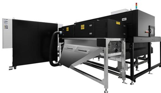
L'apparecchiatura - spiega la società giapponese - utilizza la tecnologia della spettroscopia Raman sugli oggetti in movimento sul nastro, con un meccanismo di tracciamento capace di rilevare, con elevata precisione e velocità, le diverse tipologie di materiale che costituiscono i frammenti di plastica, anche di colore nero, che - come è noto - è difficile da rilevare con i sistemi NIR convenzionali.
