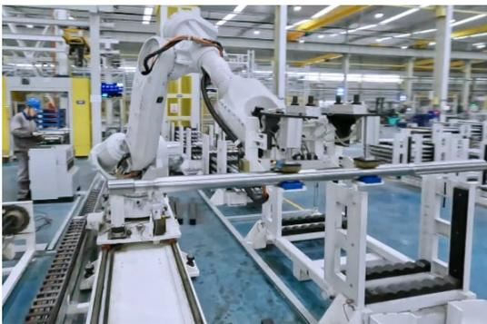
**INSERIMENTO AUTOMATICO DELLE COLONNE.** La prima fase dell'assemblaggio - senz'altro la più spettacolare - è il posizionamento delle colonne nel gruppo di chiusura, reso automatico grazie alla presenza di due robot antropomorfi che provvedono all'infilaggio nei passaggi colonne già dotati di boccole, operazione particolarmente delicata e per la prima volta resa automatica, pur sotto la supervisione dei tecnici. In questo modo si è eliminato il lavoro pesante, dovuto alla
