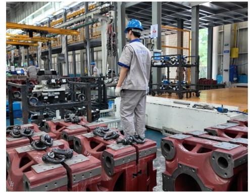
della capacità produttiva richiesta. Ci vogliono meno di 28 minuti per completare una pressa, che viene tracciata lungo tutto il percorso fino ai test finali grazie a tag RFID. Una volta controllate, le macchine vengono immagazzinate in un'area capace di contenere fino a 720 presse.
