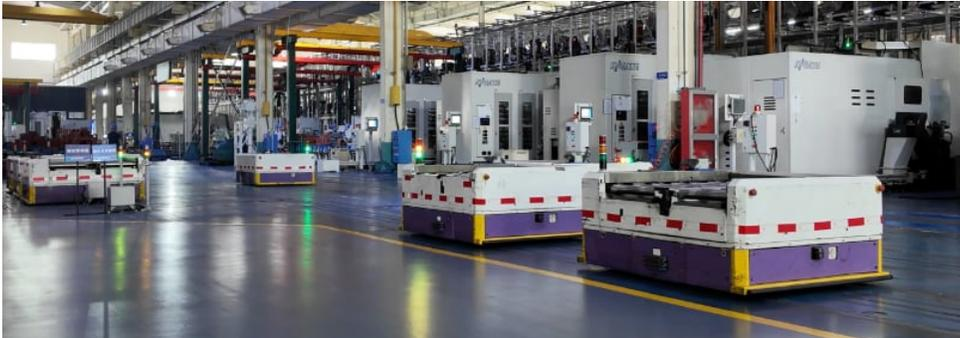
Nel nostro giro delle fabbriche di Haitian a Ningbo, in Cina ([leggi articolo](#)), abbiamo visitato quella dove il costruttore cinese sta implementando il concetto di smart factory, complemento tra forte integrazione verticale (si parte dalla lamiera e dalle fusioni per arrivare alla pressa finita) ed elevata automazione, sia nel trasporto di componenti e assemblati tra i vari reparti, sia come ausilio al lavoro più pesante nelle fasi di montaggio.
