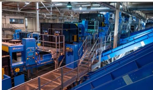
Fornito da Sorema, divisione del Gruppo Previeri, l'impianto completa a valle la selezione (nella foto), provvedendo al lavaggio e a una serie di lavorazioni di tipo meccanico e termico che consentono di ottenere scaglie in PET, HDPE e PP riciclato di qualità elevata, da immettere nel mercato delle materie prime seconde.
