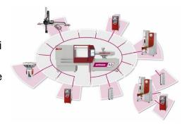
centralmente, o controllare da remoto l'intera isola, integrando eventualmente sistemi di altri costruttori attraverso il protocollo OPC UA. Concetto che Wittmann definisce Smart Work Cell nella più ampia accezione del programma Wittmann 4.0, basato su un router che si occupa di comunicare i dati in modo sicuro e su un software MES proprietario, Temi+, in grado di gestire i dati a livello di reparto o stabilimento e trasformarli in informazioni utili per chi prende decisioni (KPI).
