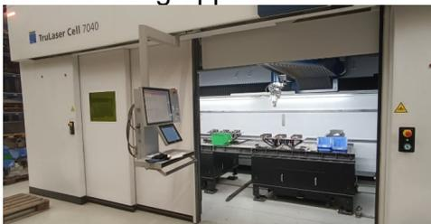
Tra i macchinari più interessanti troviamo un centro di saldatura laser automatico (nella foto), servito da due robot antropomorfi che si muovono su un binario lungo sei metri. Viene utilizzato per realizzare i basamenti delle presse, anche quelli destinati ai modelli di maggior tonnellaggio assemblati a Kottlingbrunn; processo che richiede circa tre
