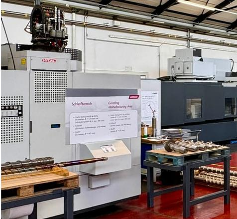
Nella sede storica di Battenfeld, a Kottlingbrunn, oltre all'assemblaggio delle presse orizzontali di medio e grande tonnellaggio, di quelle verticali e per microstampaggio (MicroPower), vengono anche sagomate viti e punzoni ed effettuati, in silos interrati, i trattamenti di nitrurazione gassosa per l'indurimento superficiale, prima della lucidatura.
