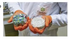
Il processo si basa sulla piattaforma C-Zyme di Carbios, dove un enzima provvede a depolimerizzare PET e fibre poliestere, riportandoli ai costituenti di partenza: acido tereftalico e glicole monoetilenico, i quali, dopo essere stati sottoposti a una fase di purificazione, possono essere riutilizzati per produrre nuovamente poliestere con una qualità pari al vergine e ulteriormente riciclabile a fine vita.
