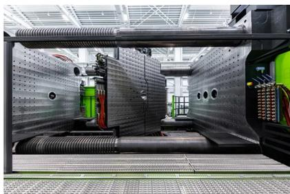
Per garantire la massima flessibilità operativa, la macchina a due piani del costruttore austriaco consente di testare anche processi non comuni come clearmelt per il rivestimento poliuretano dei pezzi, possibilità di combinare diversi materiali e colori (combimelt), schiumatura per alleggerimento (foammelt), stampaggio di materiali compositi (organomelt), inietto-compressione (coinmelt) e produzione di parti ottiche
