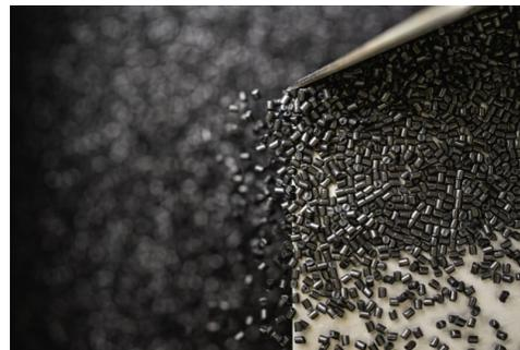
Le istituzioni che aderiranno al programma avranno accesso ai materiali formulati per stampaggio ad iniezione e stampa 3D al fine di condurre prove e sperimentazioni. Si tratta di oltre 150 compound a base di polimeri ingegnerizzati (HDPE, POM, ABS, PET-G) fino a tecnopolimeri ad alte prestazioni (PEI, PESU, PEEK, PPS), rinforzati con fibre di carbonio o di vetro.
