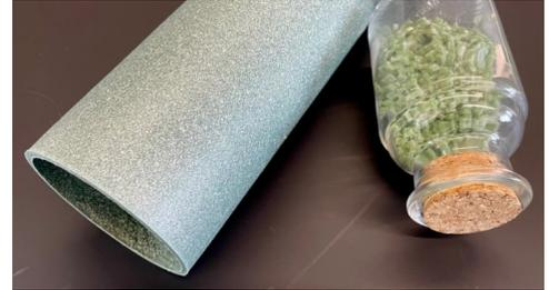
Il cliente ha potuto anche verificare, su una linea pilota, i dati di laboratorio. Il PolyAl di scarto è stato infatti testato su un estrusore bivate controrotante MD30 da laboratorio, al fine di confermare l'idoneità della soluzione allo scale-up a livello industriale, in termini di valori di amperaggio, reggispinta e pressione in testa.
