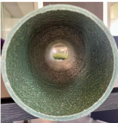
Ciò che esce dall'estrusore - sostiene Bausano - è un tubo robusto e dalla superficie liscia al tatto, sia internamente che esternamente, ideale per avvolgere bobine di stoffa, film, carta e altri materiali. Un prodotto che può sostituire le convenzionali anime in cartone o in polimero vergine.
