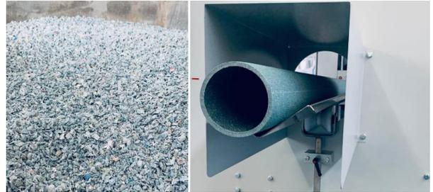
Questi contenitori sono composti in gran parte da cartone (75%), con all'interno strati barriera di polietilene a bassa densità (20%) e alluminio (5%). Il materiale che si ottiene dai contenitori tipo 'tetrapak' una volta separata la frazione cellulosa può essere estruso in tubi per anime, trovando così una nuova applicazione.
