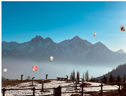
“Esistono già sonde atmosferiche in grado di rilevare alcuni parametri dell’aria attraversando in verticale la troposfera - spiega Daniela Tordella, docente presso il DISAT -. La nostra, però, è una sonda a basso costo, leggera ed ecosostenibile, in grado di esplorare in modo endoscopico (cioè dentro) l'atmosfera su lunghe distanze sia orizzontali che verticali e su ampie finestre temporali. Uno strumento che per le sue caratteristiche può essere usato con maggiore facilità ed economicità”.
