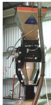
La tecnologia LineMaster - spiega la società in una nota - ha consentito a Prysmian di migliorare il controllo del dosaggio delle diverse materie prime utilizzate nella produzione dei cavi, essenziale per ottenere il corretto equilibrio tra resistenza al fuoco e resistenza meccanica.
