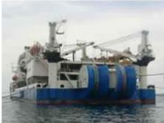
Il sistema in cavo HVDC fornito da Prysmian include cavi di tensione  $\pm 300$  kV DC per il collegamento sottomarino (circa 125 km) e terrestre (circa 75 km) con la stazione di conversione di Diele, vicino Papenburg (circa 200 km di tracciato in totale). Altri 39 km di cavo sottomarino estruso da 155 kV in corrente alternata collegheranno le piattaforme dei trasformatori dei parchi
