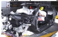
L'avveniristico progetto, che avrà riflessi positivi sulle tecniche di produzione dei veicoli e sulla lavorazione dei materiali avanzati, si basa sul concetto LifeDrive, una struttura costituita da due moduli indipendenti: il Drive, in alluminio, accoglie le batterie, il propulsore elettrico, la catena cinematica e gli elementi a deformazione programmata; la cellula che protegge i passeggeri, denominata Life, vede invece l'impiego di compositi al carbonio, al tempo stesso leggeri e resistenti.
