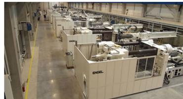
Le macchine di grande tonnellaggio – la forza di chiusura è pari a 3.500 tonnellate – sono destinate allo stampaggio di plance portastrumenti, paraurti e moduli frontali. Attualmente sono le macchine più grandi in funzione presso lo stabilimento di Montgomery.
