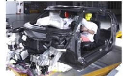
Con il nuovo veicolo elettrico, BMW sperimenterà su larga scala l'impiego di materiali compositi al carbonio per la cellula abitacolo del veicolo (modulo Life), mentre l'alluminio sarà utilizzato per il telaio (modulo Drive). In questo modo il costruttore tedesco punta a risparmiare tra i 250 e i 350 kg, compensando così il maggior peso degli accumulatori. A regime usciranno ogni anno dalle catene di montaggio 40mila esemplari di i3.
