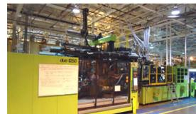
Le isole di lavoro sono basate su presse Serie duo in configurazione a due piani: una 900 WPX e due 1100 WP, con forza di chiusura rispettivamente di 900 e 1.100 tonnellate, equipaggiate con tavola rotante e tre iniettori orizzontali (1.300H, 2.000H, e 600H).
