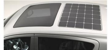
Pesa soltanto 20 kg il tetto panoramico con celle fotovoltaiche ideato da Webasto per applicazione su veicoli elettrici, per ora un semplice prototipo.
