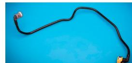
Il pezzo è stato realizzato per la prima volta in poliammide 1010 ottenuta con un minimo del 60% di risorse rinnovabili (acido sebacico ricavato da olio di ricino). Per questa applicazione, Hutchinson ha impiegato il grado per estrusione Zytel RS 1610 di DuPont, in sostituzione della poliammide 12 utilizzata in precedenza.
