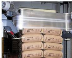
Manuli Stretch sottolinea anche l'elevata trasparenza del film, che facilita la lettura dei codici a barre e migliora la visibilità delle merci pallettizzate; il materiale non si attacca al materiale imballato grazie all'assenza di calore durante l'utilizzo e protegge contro umidità e polvere.
