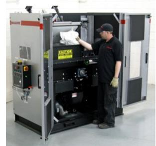
Il sistema consente il riciclo degli spurghi del processo di estrusione, che si generano nei cambi di lotto o di produzione; normalmente, questi materiali vengono scaricati a terra e lasciati indurire per poi essere raschiati e avviati in discarica.
