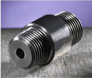
La brasiliana Escontrol è passata al PEEK dovendo riprogettare la linea di connettori isolanti utilizzati all'interno della strumentazione termica per serbatoi ad alta pressione. Per questa applicazione è stato selezionato un tecnopolimero della serie ST fornito da Victrex, al posto di un grado PTFE utilizzato in precedenza.
