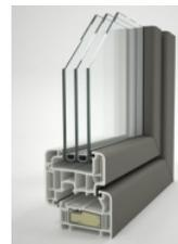
Gli inserti in metallo sono utilizzati per irrigidire i profili di porte e finestre in materiale plastico, al fine di evitare deformazioni nell'uso prolungato. Pur essendo poco costosi e robusti, hanno lo svantaggio di trasmettere il calore, formando ponti termici che riducono il valore di isolamento termico del serramento. Per questa ragione, nei profili di ultima generazione sono talvolta sostituiti con elementi in materiale plastico fibrorinforzato.
