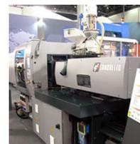
In fiera saranno anche esposte tre macchine serie EN, con forza di chiusura di 70, 150 e 200 tonnellate, presse idrauliche equipaggiate con pompe ad inverter per contenere i consumi energetici, disponibili in catalogo fino alla versione da 450 tonnellate di forza di chiusura.
