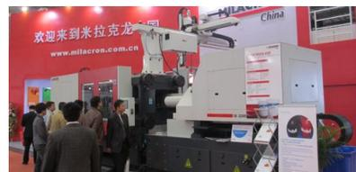
Equipaggiata con unità di iniezione 2.290 (esiste anche la versione da 3.470), vite con diametro di 70 mm e stampo di produzione locale, la pressa produceva in Fiera un secchiello in polipropilene decorato, dalla capacità di 4,5 litri. Secondo il direttore generale di Ferromatik Milacron, Gerold Schley, sono state già vendute cinque macchine di questa taglia a stampatori in Germania, Cina e Arabia Saudita.
