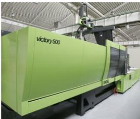
La tecnologia Engel gasmelt sarà invece implementata sulla nuova victory 3550/500 tech (foto a sinistra), con forza di chiusura di 500 tonnellate, dotata di azionamento ecodrive e robot lineare viper 40, per la produzione di casalinghi in polipropilene. La tecnologia di svuotamento con gas rende i componenti più leggeri e quindi più maneggevoli, riducendo inoltre il peso del materiale ed i costi, senza compromessi in termini di resistenza e
