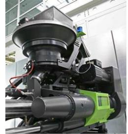
Segnaliamo infine, tra le numerose proposte, l'allestimento di una pressa elettrica e-motion 740/180 T WP con sistema roto feeder (foto sopra) per la produzione di parabole per gruppi ottici anteriori. Il sistema di alimentazione in continuo, a pressione costante, messo a punto dal costruttore austriaco assicura affidabilità di processo nella lavorazione di BMC e HTV.
