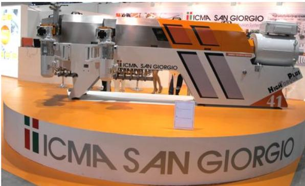
In mostra a Milano anche l'estrusore bivate corotante HT dotato di due alimentazioni laterali, sviluppato per lavorare polietilene e polipropilene caricati fino al 70% con carbonato di calcio o biossido di titanio, come pure PP o PA rinforzati fino al 50% con fibra di vetro o talco.
