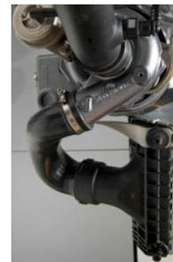
E' destinato ad applicazioni sottocofano, in particolare nella produzione di manicotti del turbocompressore e condotti aria, il nuovo grado Vamac Ultra HT proposto da DuPont Performance Polymers. Si tratta di un elastomero etilene-acrilico (AEM) della gamma Vamac Ultra, con migliorata resistenza termica, in continuo fino a 180°C, ma capace di sopportare temperature di picco fino a 200°C.
