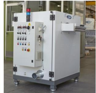
Nel settore dell'estrusione, la sfida è rispondere alle richieste dei trasformatori che si trovano a granulare rifili da film e lastra sempre più tenaci e spessi: qui entrano in gioco le due nuove macchine TRK (foto a destra), progettate per il recupero in linea di rifili in polistirene, polipropilene, PET e poliammide con spessori da 0,1 a 3 mm.
