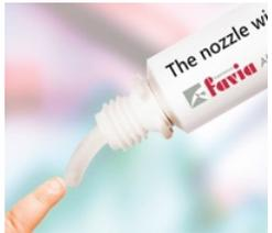
Tubetto con bocchello in plastica con punta morbida di Tubettificio Favia (a sinistra). Il bocchello, applicato su un tubetto di alluminio, facilita l'applicazione di prodotti oftalmici e cosmetici. Viene stampato con una pressa bicomponente utilizzando una miscela di polietilene ad alta e bassa densità per la base (più rigida per agganciarsi al tubetto) ed elastomero termoplastico per la punta, morbida e flessibile.
