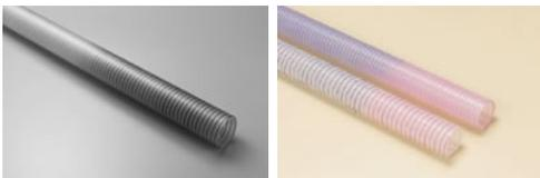
Essendo costituito da tre diversi pigmenti, mescolati tra loro, il materiale è in grado di visualizzare qualsiasi tonalità di colore, dal bianco al nero, nel range di temperature da  $-10^{\circ}\text{C}$  a  $+60^{\circ}\text{C}$ . Il tubetto è stato sviluppato per evidenziare variazioni di temperature di mezzo grado centigrado rispetto al limite impostato.
