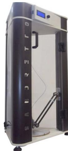
Le stampanti, disponibili in tre diverse taglie, in funzione del diametro del piatto riscaldato (SND R250, R400 e R700), presentano un'architettura a Delta e operano per deposizione di filo fuso con tutti i materiali attualmente in distribuzione. Sandretto pensa di ampliare a breve la gamma introducendo modelli su base cartesiana per le produzioni di serie.
