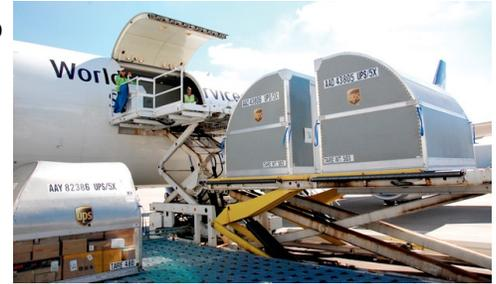
**CON FIBRE ARAMIDICHE.** I container MacroLite ULD, già testati da UPS, sono più leggeri e possiedono una vita utile più lunga rispetto alle unità in alluminio, che rappresentano lo standard per il trasporto aereo, dove ogni chilogrammo di tara rappresenta un kg in meno di carico utile.
