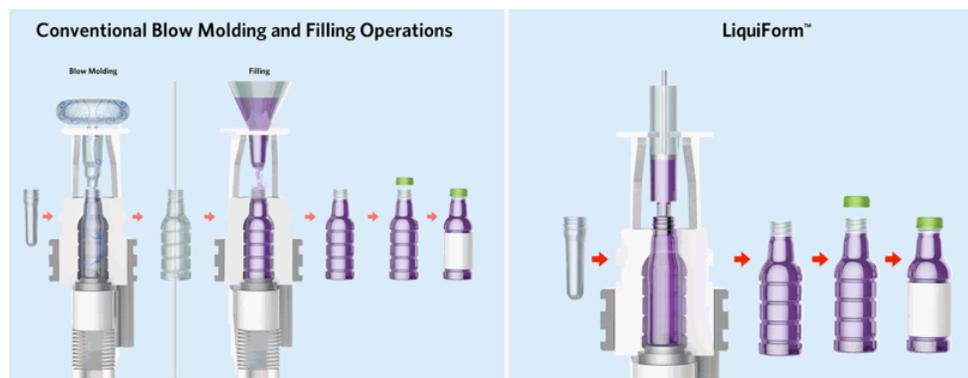
Una volta inserita la preforma nello stampo, invece di iniettare aria compressa per dare la forma finale alla bottiglia, come nel soffiaggio tradizionale, si introduce direttamente il liquido da imbottigliare, in pressione, quindi si si tappa il contenitore. L'unica accortezza è progettare ad hoc le preforme, che prima di passare nella macchina devono essere condizionate in forno.
