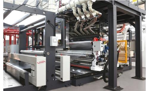
La linea conta tre stazioni: due in testa piana (cast) - una per resine barriera (PA) e una per poliolefine (LDPE, LLDPE e ionomeri) – e una centrale di laminazione per estrusione nella quale vengono accoppiati i due film. Il risultato è una struttura PA/PRIMER/PE+PE/PE+PE+PE con larghezza netta di 1.800 mm su bobine del diametro di 800 mm. La produttività oraria si attesta tra i 600 e i 900 kg/ora, in base allo spessore.
