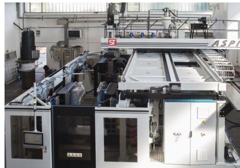
Particolarità della macchina è il gruppo testa-estrusore che alimenta non una, ma due unità di chiusura indipendenti, ognuna con forza di 200 kN.
