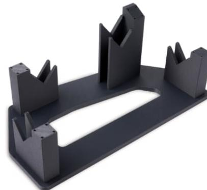
Battezzato FDM ABS-CF10, il composito presenta un tenore di fibre di carbonio corte del 10%, proponendosi così come alternativa al metallo in componenti tecnici: è infatti 15% più resistente e oltre 50% più rigido dell'ABS standard, più leggero del metallo e può essere stampato con un elevato grado di precisione. Il materiale solubile in acqua QSR Support rende possibile la stampa 3D di parti complesse e intricate senza richiedere la rimozione manuale del supporto.
