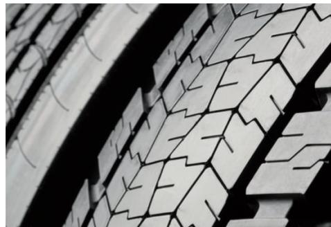
Un risultato frutto della combinazione di un elastomero ottimizzato da Arlanxeo con una silice altamente dispersibile (HDS ) appositamente sviluppata da Solvay per garantire un'elevata interazione a livello molecolare con la matrice. Grazie alla collaborazione dei due partner, lo sviluppo è stato completato in soli 24 mesi.
