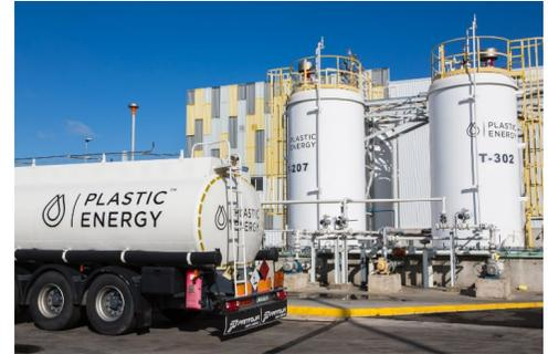
La tecnologia di riciclo chimico TAC (Thermal Anaerobic Conversion) messa a punto da Plastic Energy prevede la conversione termochimica, in assenza di ossigeno, di rifiuti di plastica mista (difficili da riciclare per via meccanica) in un olio sintetico (Tacoil), che può essere impiegato come materia prima per produrre nuove materie plastiche e biocarburanti.
