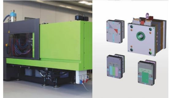
A questo scopo, il compoundatore tedesco si è dotato di un nuovo stampo con il quale è possibile sostituire rapidamente le matrici per lo stampaggio ad iniezione dei provini da laboratorio utilizzati nei test per valutare fluidità, qualità superficiale e adesione dei compound formulati nel laboratorio.
