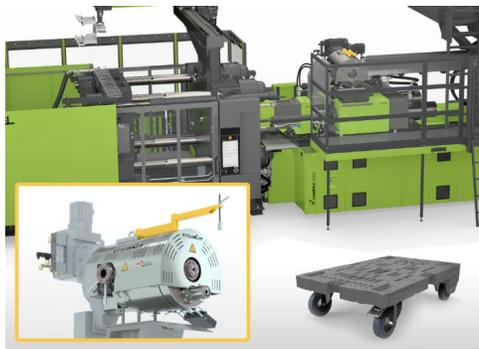
Il processo di stampaggio è stato suddiviso in due fasi indipendenti, ma sincronizzate: nella prima, le scaglie di materiale plastico da sfrido industriale o post-consumo vengono fuse in una convenzionale vite di plastificazione. Il fuso viene quindi trasferito a una seconda vite prima dell'iniezione nello stampo.
