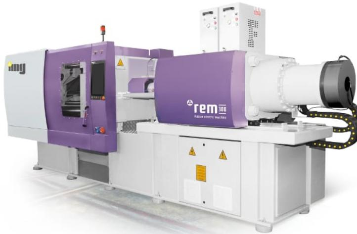
Il costruttore bresciano di presse ad iniezione per elastomeri IMG lancerà al K2022 la nuova serie di macchine ad iniezione completamente elettriche REM, presentando in Fiera il primo modello con forza di chiusura di 300 tonnellate. L'azionamento full-electric, afferma l'azienda, consente di ridurre i costi energetici e operativi fino al 40%, ha un minor impatto ambientale grazie all'efficienza energetica e all'assenza di olio, ed è più veloce e precisa delle corrispondenti presse oleodinamiche.
