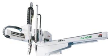
Il secondo robot Star sarà ospitato presso lo stand PPI. Si tratta in questo caso di un modello Es-1000II con controllore STEC-NC2 montato su una pressa Yizumi UN90A5 equipaggiata con stampo monocavità fornito da Stamec One. Il robot si occuperà dell'estrazione del pezzo, una maschera del carnevale veneziano in polistirene, prodotta con un tempo di ciclo di 22 secondi.
