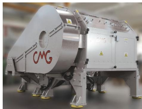
Oltre alla precisione al centesimo di millimetro nella costruzione della camera di taglio, che assicura una lunga durata delle lame, tutti i modelli della serie Evoluzione sono dotati di controlli avanzati Industria 4.0: parametri come temperatura d'esercizio, usura lame, produttività, efficienza operativa, utilizzo energia, possono essere gestiti a bordo macchina o da remoto con connettività basata su protocollo OPC-UA.
