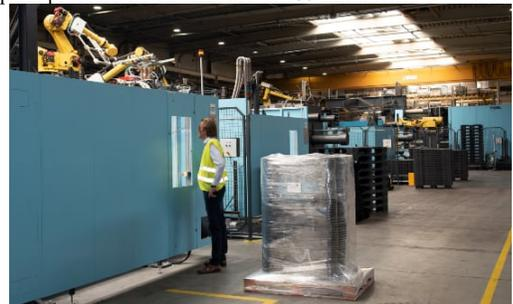
Le due nuove presse sono state recentemente dotate di stampi multipiano in cui vengono iniettate le due metà del pallet, superiore e inferiore, successivamente assemblate a incastro. "Attualmente ci serviamo di quattro stampi di questo tipo, che vengono utilizzati per la produzione di pallet chiusi" nota Vally Hoogland.
