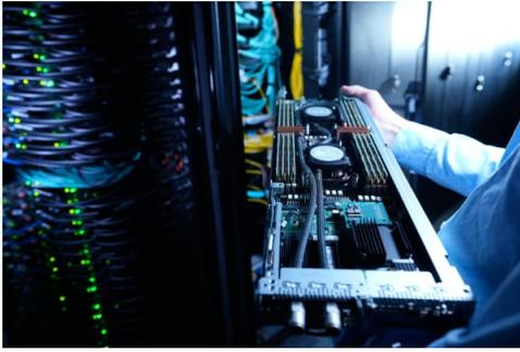
Curiosity come il suo predecessore, il nuovo sistema di elaborazione utilizza processori AMD (CPU), ha una capacità di memoria pari a 3.000 terabytes e adotta un raffreddamento innovativo ad acqua, che assorbe il calore direttamente dove viene generato e lo trasporta al sistema di raffreddamento, riducendo notevolmente il fabbisogno energetico e, quindi, i costi operativi.
